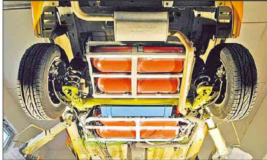
Zusätzlicher Platzbedarf: Erdgastanks werden häufig unter dem Fahrzeugboden montiert. Die Umrüstung auf Autogas ist mit weniger Aufwand als bei Erdgas machbar. Foto: dpa
